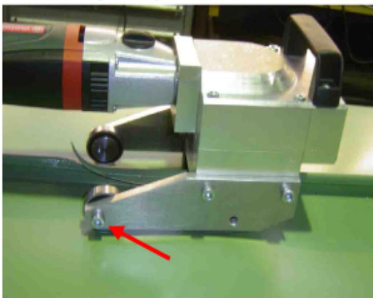
Um den Schneidwinkel zu korrigieren, wird ein Innensechskantschlüssel SW 6 benötigt. Damit lösen Sie die Schraube am Exzenter und verdrehen ihn in die entsprechende Richtung. Sie stellen damit die hinteren Führungsräder höher oder tiefer.
